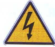
Tehlikeli elektrik gerilimine karşı ikaz
